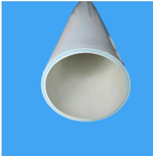
聚乙烯(PE)管构造: 聚乙烯(PE)树脂为主要原料、经挤出成型的给水管材。聚乙烯(PE)管特点: PE管加工时不添加重金属盐稳定剂，材质无毒性，无结垢层，不滋生细菌，很好地解决了城市饮用水的二次污染。除少数强氧化剂外，可耐多种化学介质的侵蚀；无电化学腐蚀。在额定温度、压力状况下，PE管道可安全使用50年以上。PE管韧性好，耐冲击强度高，重物直接压过管道，不会导致管道破裂。PE管热熔或电熔接口的强度高于管材本体，接缝不会由于土壤移动或活载荷的作用断开。管道质轻，焊接工艺简单，施工方便，工程综合造价低。聚乙烯(PE)管应用领域：应用于室内、外低温给水管道等。陕西HDPE聚乙烯单叶片螺旋排水管材销售价格买新型管到上海隆塑管业。
